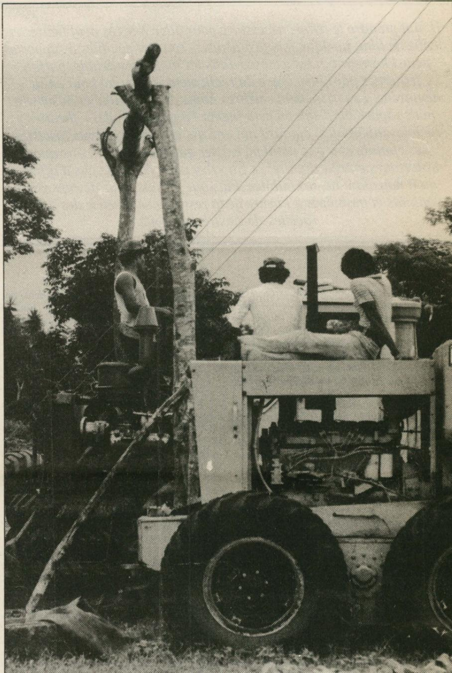
Atelier de réparation de machines agricoles, à San Miguelito. Le poteau en bois est un palan pour soulever les moteurs des engins en réparation.
